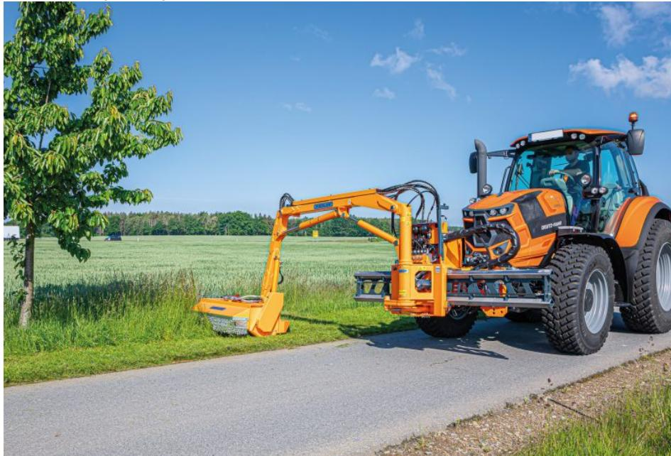
Fiedler entwickelt und produziert Frontausleger, die an jedem Fahrzeug mit einer Frontanbauplatte montiert werden können (Bild: Fiedler).
