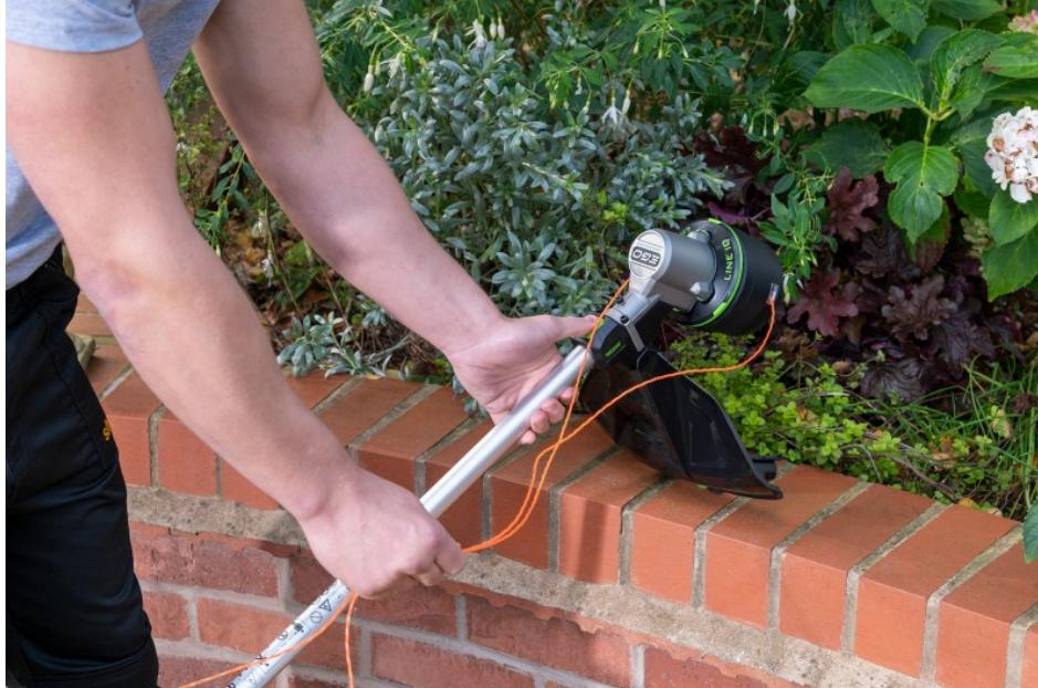
Mit der »Powerload«-Funktion entfällt das mühsame Laden und Aufziehen eines neuen Fadens. Dieser wird auf Knopfdruck automatisch eingezogen – und das in weniger als 10 Sekunden (Bild: EGO).
