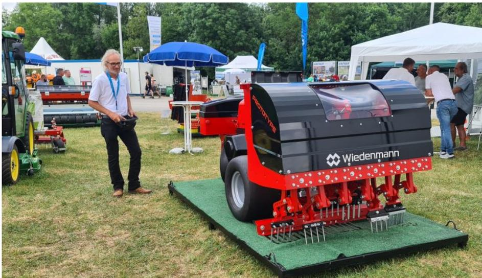
Branchenneuheit: Selbstfahrender Aerifizierer »Terra Core 6 ID«. Assistenzsysteme und Fernsteuerung erleichtern die Bedienung und verbessern das Arbeitsergebnis (Bild: Wiedenmann).
