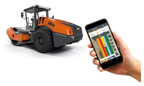
Mit der App »Smart Doc« können sehr einfach Verdichtungsreports zur Eigenüberwachung und zur Dokumentation erstellt werden (Bild: Hamm).
