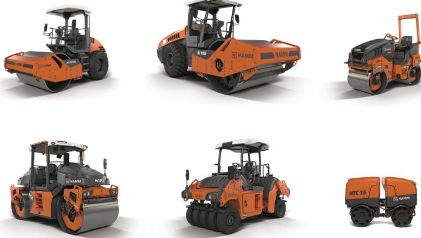
Auf der »CONEXPO/CON-AGG 2023« stellte Hamm zahlreiche neue Serien und Modelle vor: die Serie »HC CompactLine«, die Serie »HC«, elektrisch angetriebene Kompaktwalzen aus der Serie »HD CompactLine«, die Serie »HX«, die knickgelenkte Gummiradwalze »HP 100i« sowie die Grabenwalze »HTC 15« (von links oben nach rechts unten). Zudem wurde eine Tandemwalze aus der Serie »HD+« mit zwei VIO-Banden präsentiert (Bild: Hamm).
