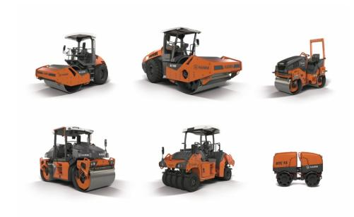
Auf der »CONEXPO/CON-AGG 2023« stellte Hamm zahlreiche neue Serien und Modelle vor: die Serie »HC CompactLine«, die Serie »HC«, elektrisch angetriebene Kompaktwalzen aus der Serie »HD CompactLine«, die Serie »HX«, die knickgelenkte Gummiradwalze »HP 100i« sowie die Grabenwalze »HTC 15« (von links oben nach rechts unten). Zudem wurde eine Tandemwalze aus der Serie »HD+« mit zwei VIO-Bandagen präsentiert (Bild: Hamm).
