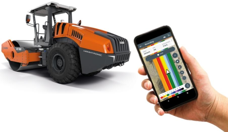
Mit der App »Smart Doc« können sehr einfach Verdichtungsreports zur Eigenüberwachung und zur Dokumentation erstellt werden (Bild: Hamm).
