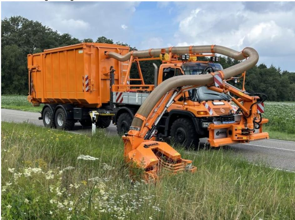
Das Schnittgut wird direkt abgesaugt und in einen Auffangcontainer befördert (Bild: Dücker).
