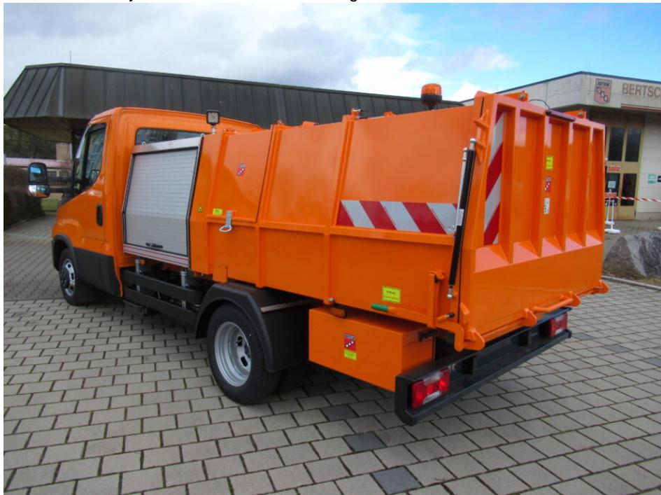
IVECO »Daily« (40-NP HI-Matic BLUE POWER) Gasfahrzeug mit Bertsche Leichtmüllverdichter »LM3,6« mit großem Zwischenbehälter (Bild: Bertsche).
