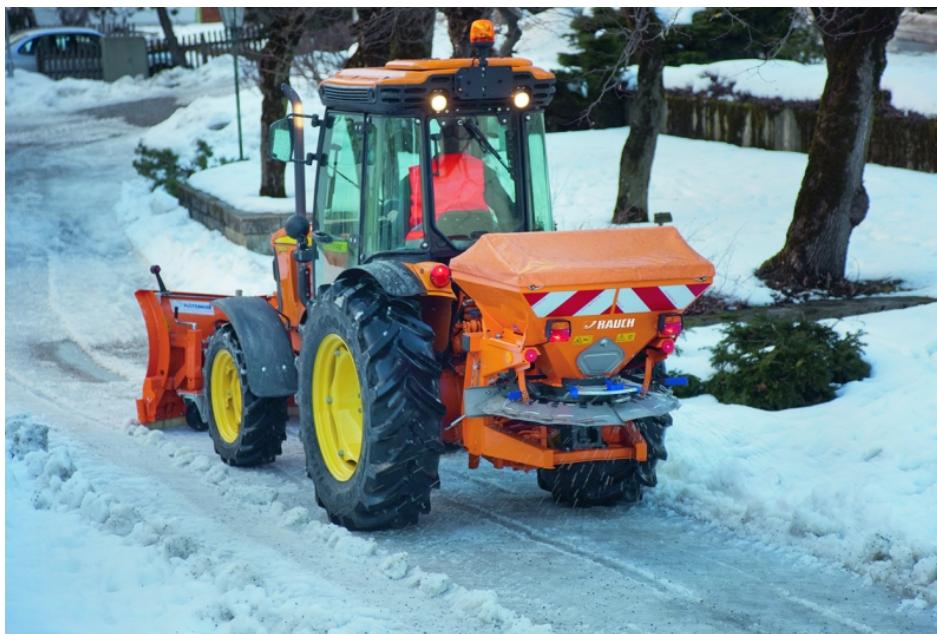
Ein besonderes Kennzeichen eines jeden Rauch-Streuers sind die präzisen Streubilder mit steil abfallenden Streuflanken, und das auch bei hohen Fahrgeschwindigkeiten und Ausbringmengen (Bild: Rauch).
