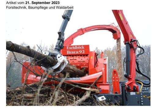
Der »Biber 92 ZK« mit Kranbeschickung kann Stämme bis max. 75 cm Duchmesser verarbeiten (Bild: Eschlböck).
