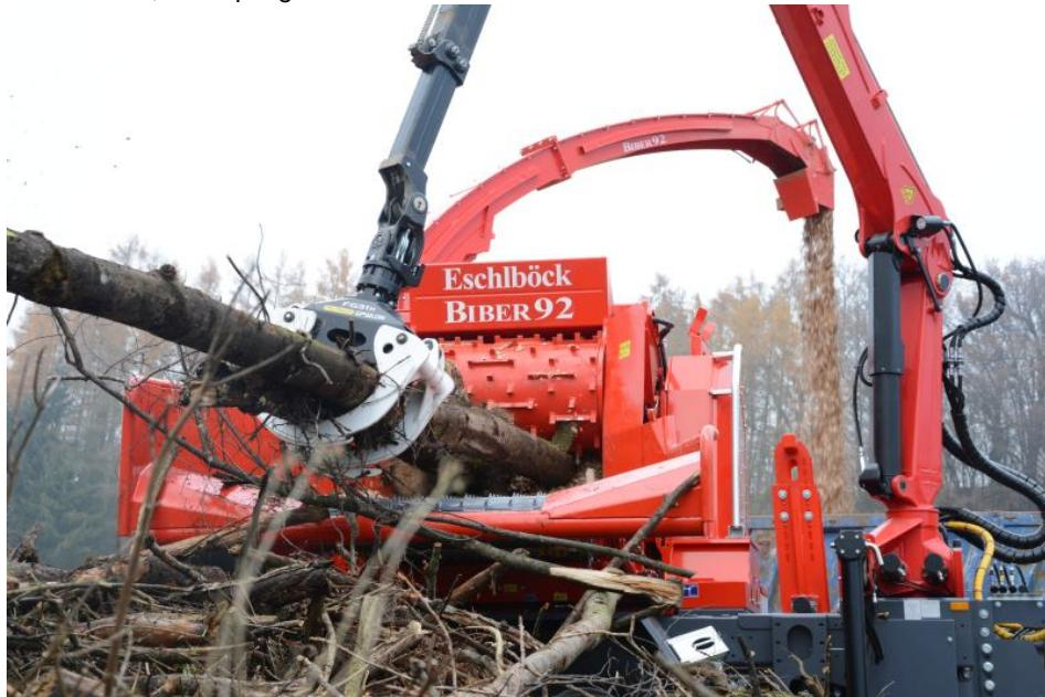
Der »Biber 92 ZK« mit Kranbeschickung kann Stämme bis max. 75 cm Durchmesser verarbeiten (Bild: Eschlöök).
