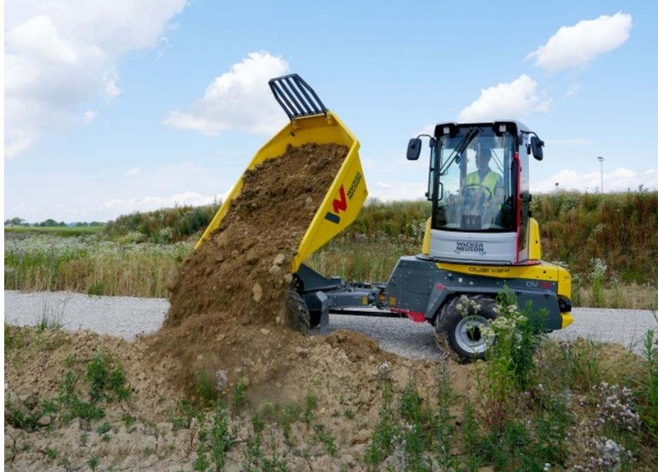
Seitlich gedrehte Kabine im Multi-View-Modus des Dumpers »DV45« (Bild: Wacker Neuson).
