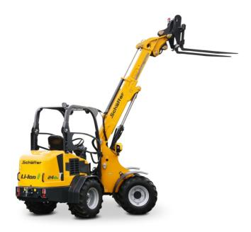
Schäffer präsentiert mit dem »24e T« das Teleradlader-Pendant seines E-Laders »24e«. Die größere Reichweite des Teleskoparms erweitert das Einsatzgebiet deutlich (Bild: Schäffer).
