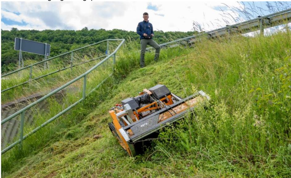
Die groß dimensionierten Raupenlaufwerke mit Stahleinlagen sorgen für geringen Bodendruck, ideale Kraftübertragung und besten Halt an steilen Hängen.
