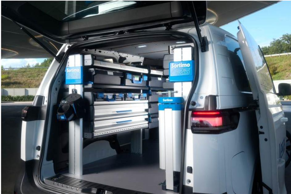
Die neue »SR5 reduced to max« Fahrzeugregalsystem-Version wurde durch eine besondere Bauweise gewichtsoptimiert, verliert dabei aber nicht an seiner hohen Stabilität (Bild: Sortimo).
