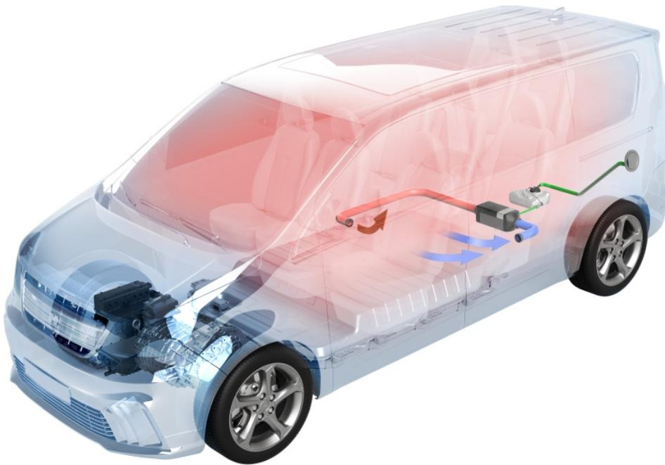
Bei dieser Nachrüstlösung für E-Transporter wird das Heizgerät zwischen Vorder- und Hinterachse montiert. Im Umluftbetrieb wird die vorgewärmte Luft aus dem Kofferraum energieeffizient genutzt und im Fußraum verteilt (Bild: Webasto).
