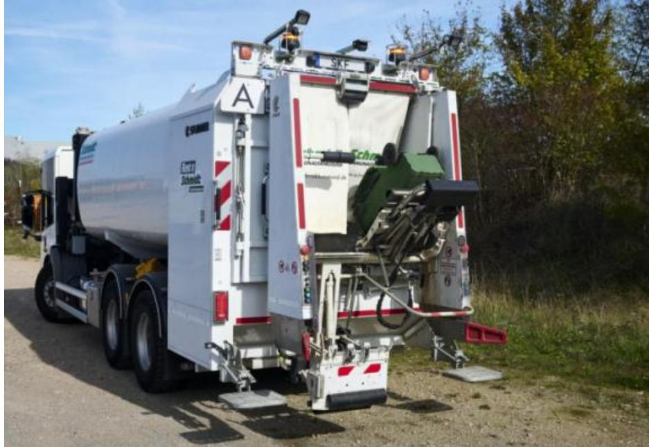
Eine am Fahrzeugheck angebaute Hochdruckpistole kann für manuelle Reinigungsarbeiten der Müllgefäß genutzt werden (Bild: Schmidt Kommunalfahrzeuge).
