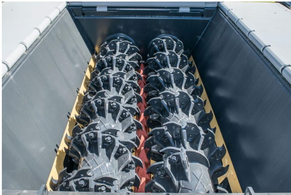
Zwei gegenläufige Walzen mit Schneidwerkzeugen sorgen für einen aktiven Einzug. Von sperrigem Strauchschnitt über Wurzelstücke bis hin zu Altholz, durchsetzt mit Störstoffen – alles wird auf eine definierte Korngröße zerkleinert (Bild: Komptech).
