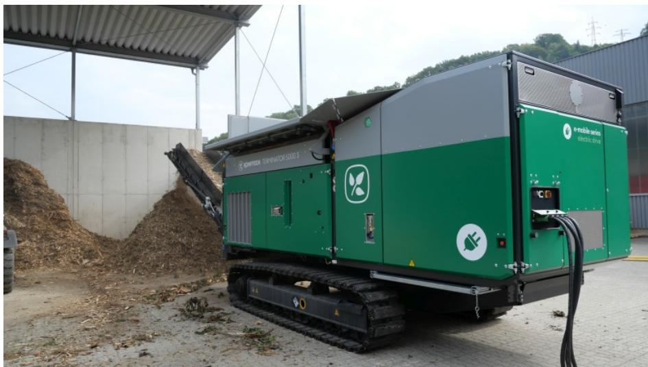
Die Erweiterung der Komptech-Produktpalette schreitet weiter voran: Nun gibt es die mobilen Zerkleinerer »Crambo e-mobile« und »Terminator e-mobile« auch mit vollelektrischem Kettenfahrwerk (Bild: Komptech).
