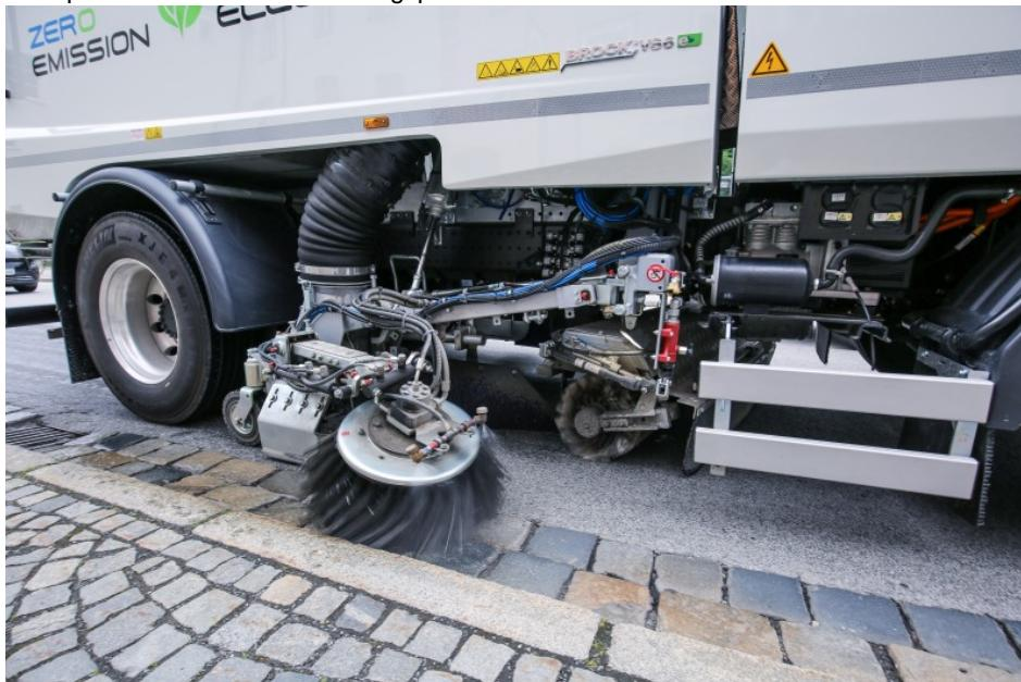
Je nach Zusatzausstattung (Front- und Seitenkehrbesen) ist eine Kehr- oder Waschbreite von 2500 mm bis 5050 mm möglich (Bild: Brock Service GmbH).
