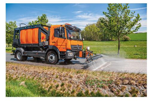
Dank der flexiblen Kaskadenbauweise lassen sich je nach Trägerfahrzeug variabel Volumen von 230 bis 17.600 l realisieren (Bild: Fiedler).
