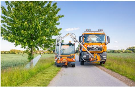
Fiedler fertigt die passende Wassertechnik in Form von modularen Wassertankbehältern, Gießarmen und Schwemmbalken für jegliche Größe von Kommunalfahrzeuge (Bild: Fiedler).
