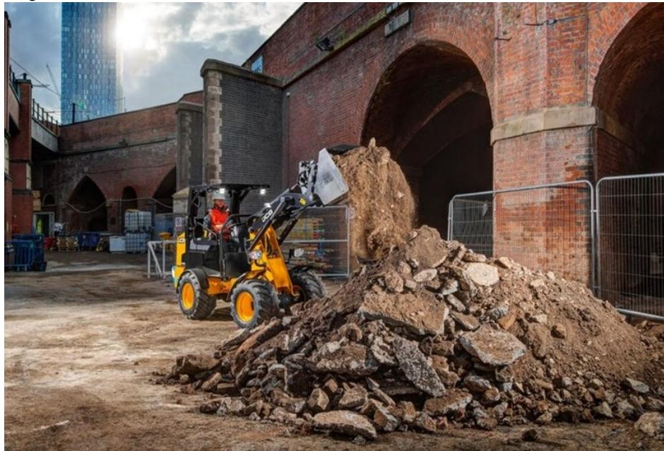
Dank seines fast geräuschlosen Motors kann der E-Radlader auch problemlos in geräuschsensiblen Bereichen betrieben werden (Bild: JCB).
