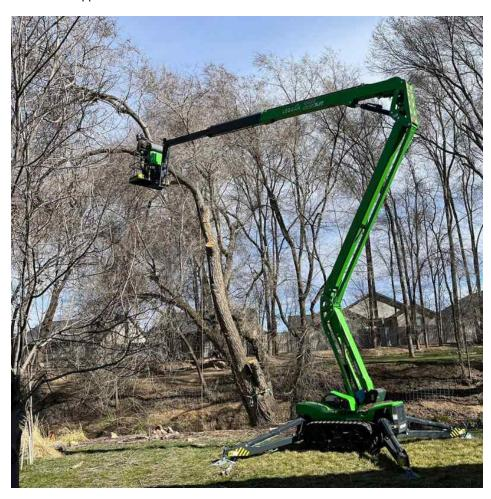
Der »Leguan 225« eignet sich für die Arbeit in anspruchsvollem Gelände und wird zum Beispiel für Baumpflegearbeiten eingesetzt (Bild: Avant Tecno).
