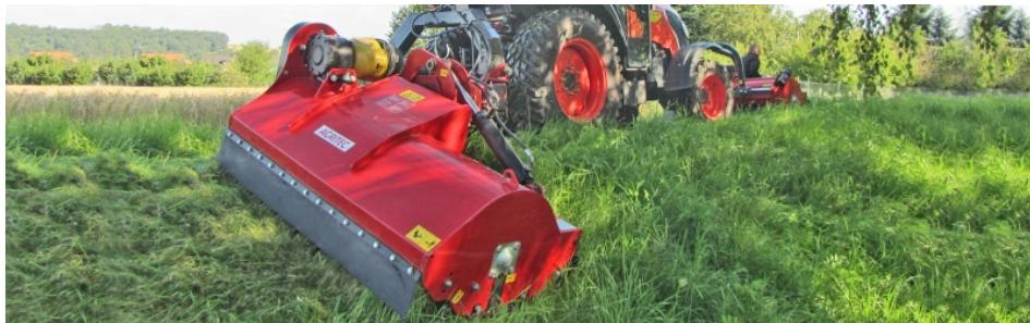
Der »GS51-P« ist ein leistungsstarker Heck- und Seitenmulcher für anspruchsvolle Pflegearbeiten entlang von Böschungen, Gräben, Straßen- und Wegrändern (Bild: Agritec).
