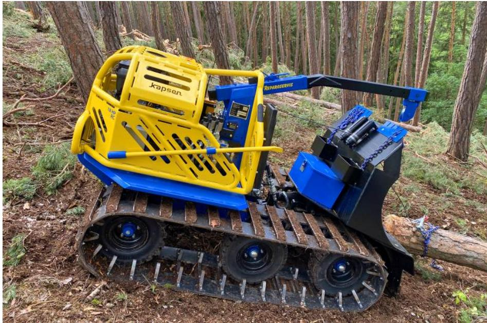
Die »Kapsen«-Forstraupe ist auch bei Eis und Schnee einsetzbar dank Metallstegen auf den Gummiketten (Bild: Reil & Eichinger).
