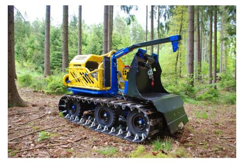
Über die großen Antriebsräder im Fahrwerk wird eine hohe Steigfähigkeit erreicht (Bild: Reil & Eichinger).
