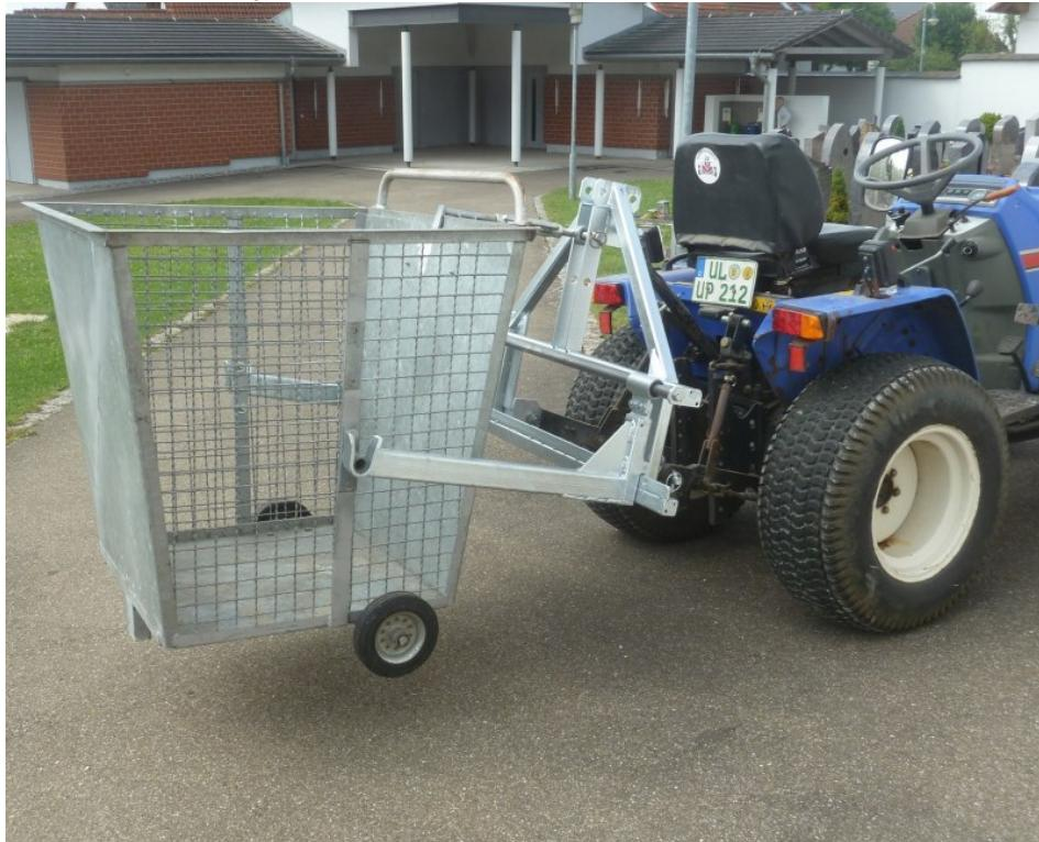
KommuTech hat eine effektive Anbaulösung zum Transport und Leerung seiner Abfallbehältern im Programm (Bild: KommuTech).
