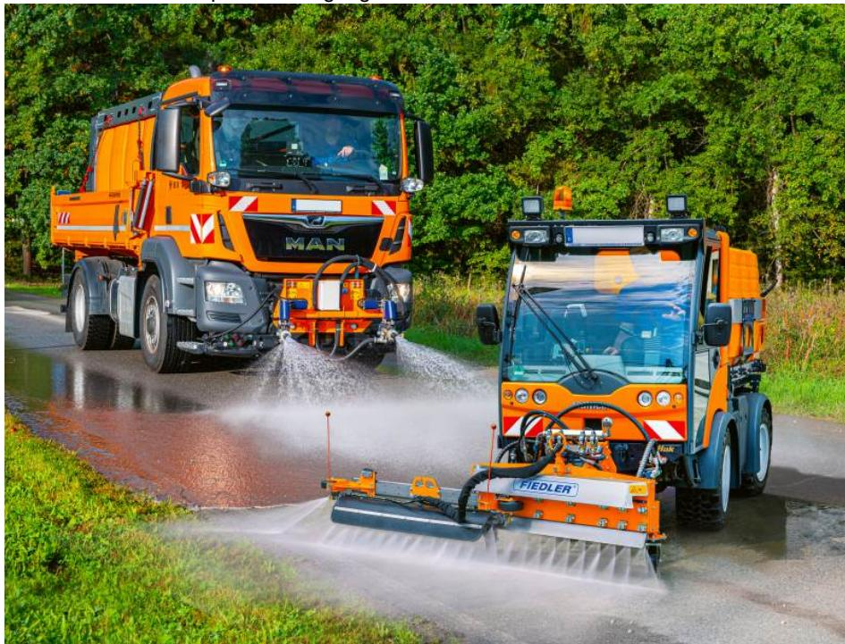
Dank der flexiblen Kaskadenbauweise lassen sich je nach Trägerfahrzeug variabel Volumen von 230 bis 17.600 l realisieren (Bild: Fiedler).
