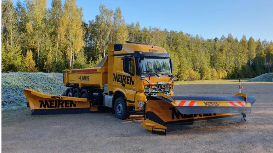
Eine räumstarke Kombination aus Seiten- und Frontschneepflug. Der Schneepflug hat eine seitliche Verschiebungsmöglichkeit und verfügt über ein patentiertes Parallelogramm mit Doppelwirkung. Diese 3-in-1-Funktion (gleichzeitiges Heben-Senken, Links-rechts-Drehung und seitliche Links-rechts-Verschiebung) bietet deutlich erweiterte Manövrieroptionen (Bild: Meiren Engineering).
