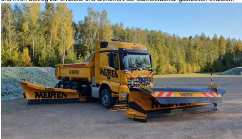
Eine räumstarke Kombination aus Seiten- und Frontschneepflug. Der Schneepflug hat eine seitliche Verschiebungsmöglichkeit und verfügt über ein patentiertes Parallelogramm mit Doppelwirkung. Diese 3-in-1-Funktion (gleichzeitiges Heben-Senken, Links-rechts-Drehung und seitliche Links-rechts-Verschiebung) bietet deutlich erweiterte Manövrieroptionen (Bild: Meiren Engineering).
