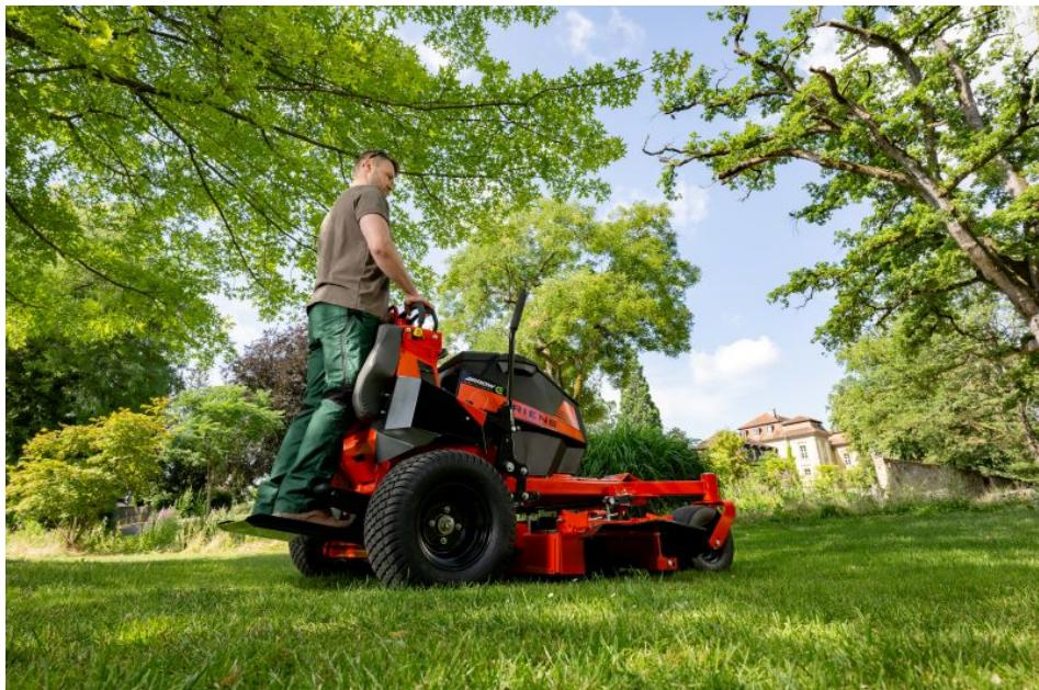
Die Vorteile des Stand-On-Mähers sind seine kompakten Abmessungen, seine hohe Wendigkeit, seine ergonomische Fahrerposition und seine hervorragende Übersichtlichkeit dank voller Sicht auf das gesamte Mähdeck (Bild: AriensCo GmbH).
