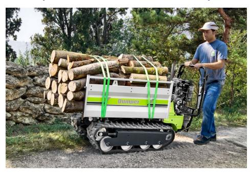
Ladungen bis 500 Kilogramm können mit dem »Dumper 507« auch auf unebenem Boden transportiert werden (Bild: Grillo Deutschland).
