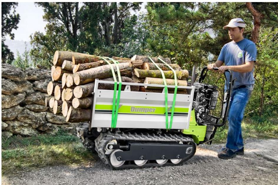
Ladungen bis 500 Kilogramm können mit dem »Dumper 507« auch auf unebenem Boden transportiert werden (Bild: Grillo Deutschland).
