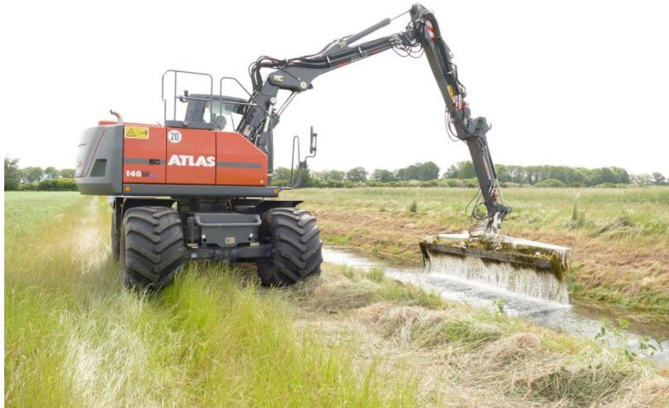
Der breite Bereifung des »Big Foot« erzeugt einen niedrigen Bodendruck und mit dem Mähkorb am Langarm hat der Bagger eine Grابتiefe von bis zu 6 Metern (Bild: Atlas).
