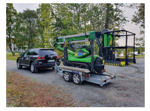
Komfortabel transportiert: Die Hubarbeitsbühne »Leguan« erfordert kein Spezialfahrzeug, um an den Einsatzort verbracht zu werden (Bild: Avant Tecno).
