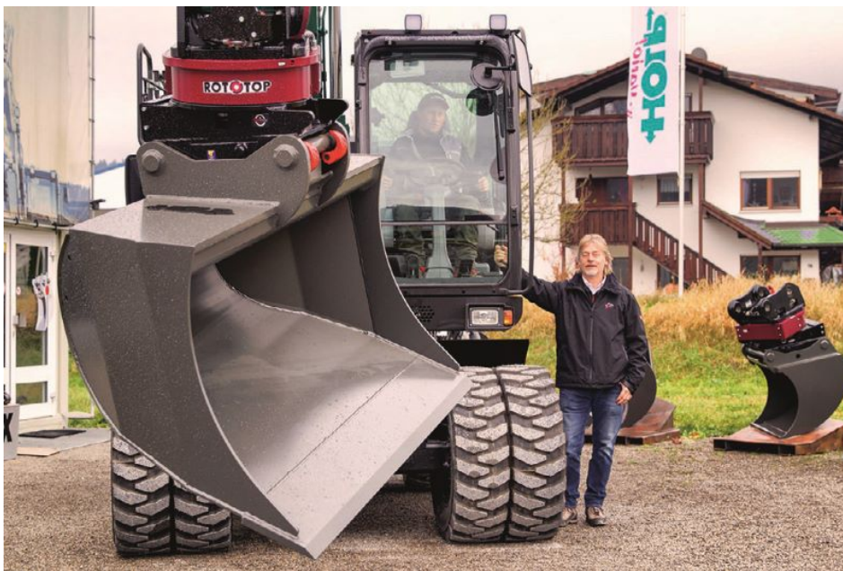
Variolöffel am »RotoTop«. Holp entwickelte den Löffel mit zwei Öffnungen für die Grabenreinigung und Bankettbearbeitung (Bild: Holp GmbH, wyynot).
