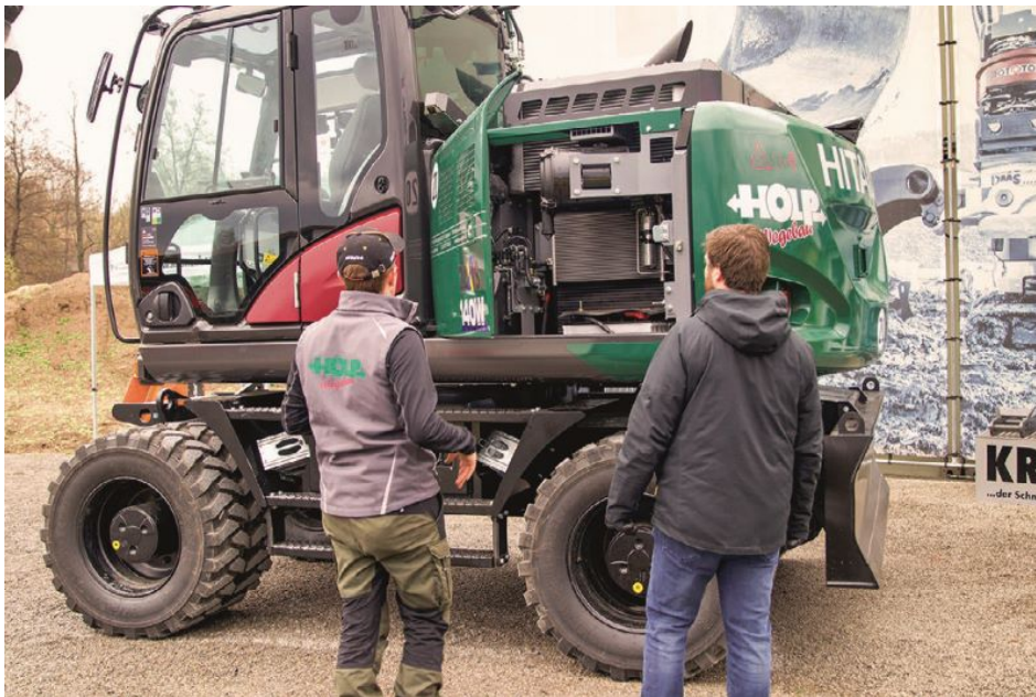
Alle Wartungspunkte sind beim »ZX140W-6« vom Boden aus über die aufklappbare Motorhaube gut erreichbar (Bild: Holp GmbH, wyynot).
