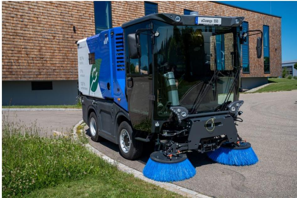
Die Schmidt »eCleango 550« kehrt elektrisch bis zu zehn Stunden am Stück und verfügt über einen 5,2 m<sup>3</sup> großen Kehrgutbehälter (Bild: Aebi Schmidt).
