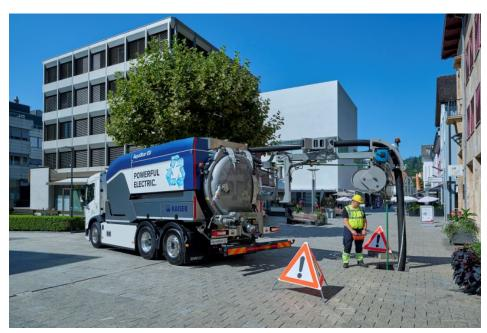
Der Kaiser »AquaStar EV« auf Basis eines Designwerk »MID CAB Sewer Cleaners 6x2R« erfüllte im Testbetrieb alle leistungs- und energieintensiven Anforderungen und bietet gleichzeitig ein großes CO2-Einsparungspotenzial (Bild: Designwerk).
