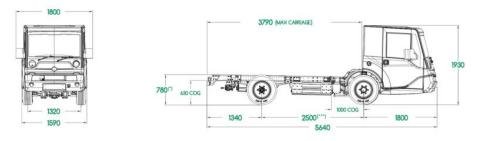
» eCarry «-Fahrgestell mit Niederflur-Fahrerhaus (Bild: Kanalreiniger.eu).
