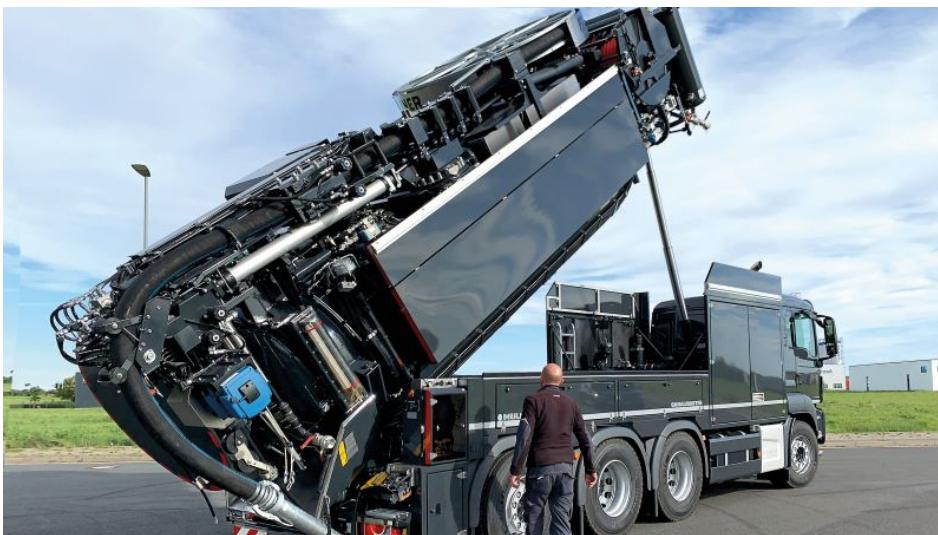
Vorteilhaft auch, dass die geräumigen Werkzeug- und Gerätefächer beim Kippen unten am Fahrzeug verbleiben (Bild: Müller Umwelttechnik).
