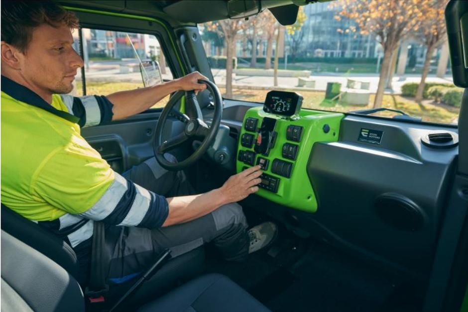
Über das Bedienelement der »Airtronic«-Luftheizung wird die gewünschte Temperatur im E-Fahrzeug eingestellt (Bild: Eberspächer).
