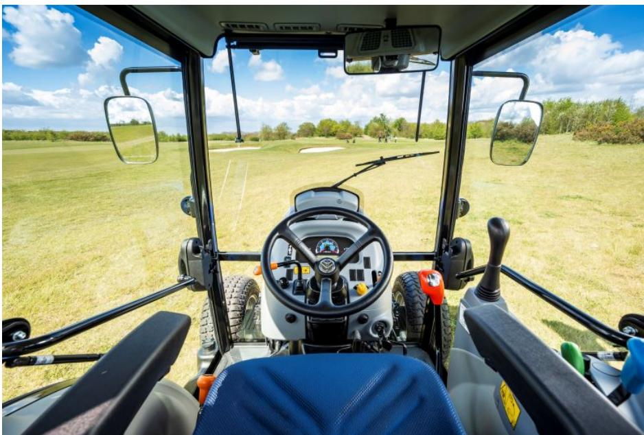
Die »Suite«-Kabine der »Boomer«-Reihe überzeugen mit zahlreichen Standardfunktionen und einem schlchten, modernen und ergonomischen Design. Die Liste der Ausstattungen umfasst Klimaanlage, Heckseitenscheiben, Radiovorbereitung, hochkomfortable Sitze (Bild: New Holland).
