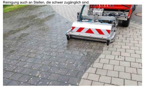
Die Arbeitsbreite des »Cleaners« beträgt 1200 mm und es ist ein Seitenverschub von je 400 mm nach rechts und links möglich (Bild: Nothhelfer).
