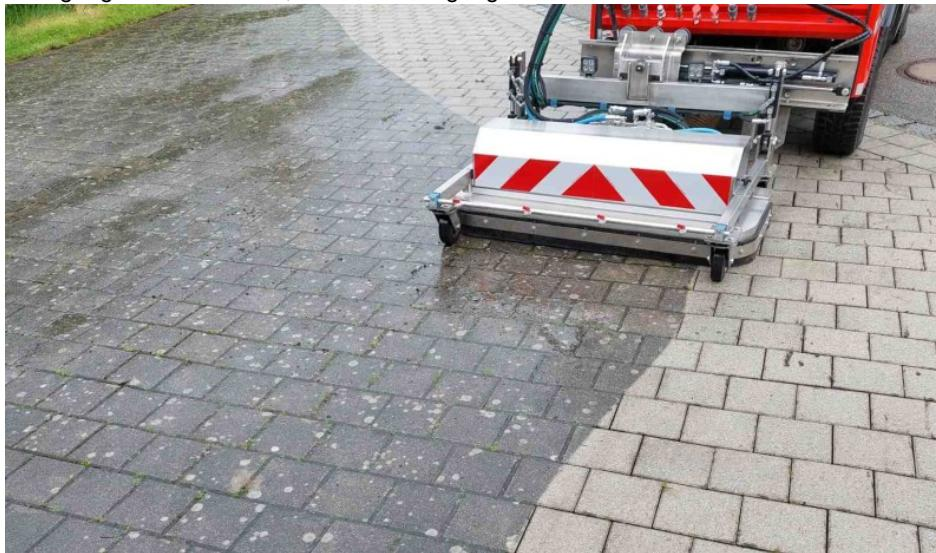
Die Arbeitsbreite des »Cleaners« beträgt 1200 mm und es ist ein Seitenverschub von je 400 mm nach rechts und links möglich (Bild: Nothhelfer).
