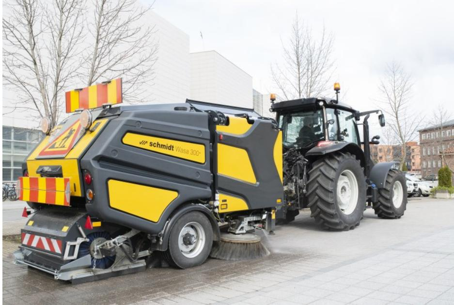
Die Schmidt »Wasa 300+« ist eine leistungsstarke Kehrmaschine mit einer sehr hohen Durchsatzleistung und einer hohen Kehrkapazität auch bei großen Schmutzmengen und grobem Kehrgut (Bild: Aebi Schmidt).
