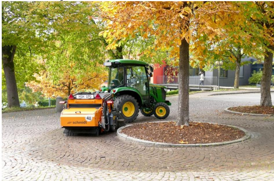
Die gezogenen »MSH«-Anhängerkehrmaschinen sind äußerst wendige und einfach bedienbare Maschinen, die auch bei engen Platzverhältnissen optimal arbeiten können (Bild: Aebi Schmidt).
