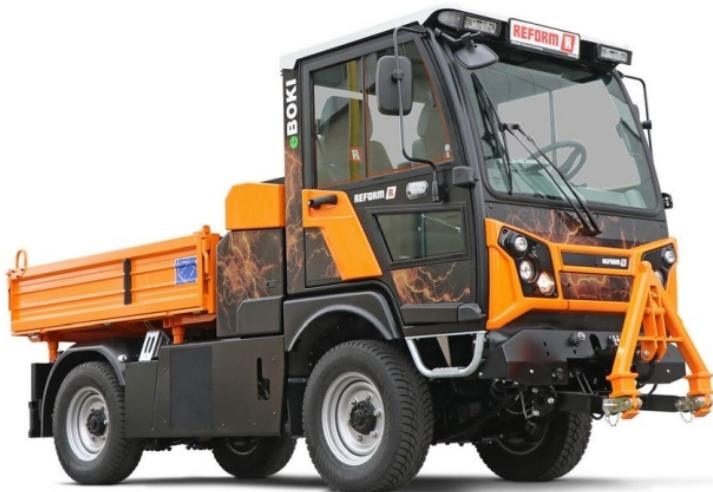
Der elektrifizierte »eBoki« besitzt einen leistungsstarken 400-Volt-Lithium-Ionen-Akku und ein spezielles Thermomanagement für den Akku (Bild: Reform),
