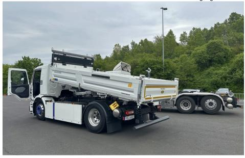
Die besondere Bauweise des »Trigenius« reduziert Gewicht und der Einsatz von hochfestem Stahl steigert die Belastbarkeit (Bild: Meiller).
