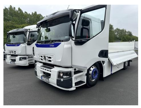
Der vollelektrische Renault Trucks »E-Tech D Wide« mit Meiller Kipper ist besonders als Bau-, Entsorgungs- und Kommunalfahrzeug interessant (Bild: Meiller).
