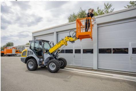
Bereits ab Werk wird eine zertifizierte Lösung mit Arbeitsplattform angeboten (Bild: Kramer).
