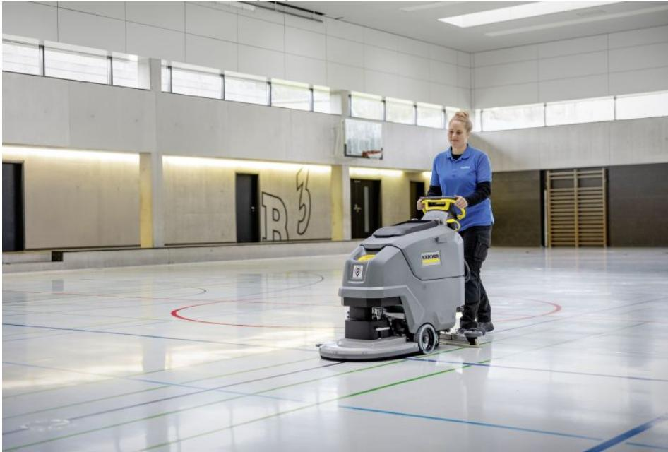
Mit einem Anpressdruck von 27 kg ermöglicht die neue Scheuersaugmaschine eine gründliche Flächenreinigung (Bild: Kärcher).
