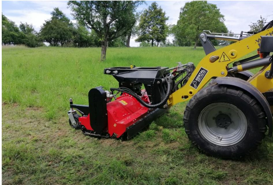
Machen Sie einen guten Schnitt mit Radladern! Mit dem neuen 3D-Anbaussystem hängt das Mulchgerät per Eigengewicht an der Gabel und wird gezogen und nicht mehr angeschoben (Bild: Agritec).
