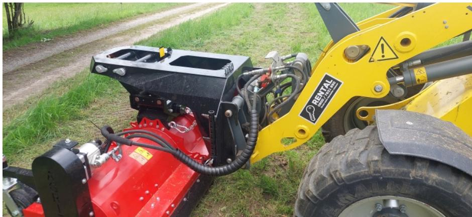
Der Mulcher bekommt dadurch seine eigene, mechanische Schwimmstellung. Das eingebaute Pendelgelenk sorgt zusätzlich für eine ausgezeichnete Bodenanpassung mit einer Art »Flow-Effekt« (Bild: Agritec).
