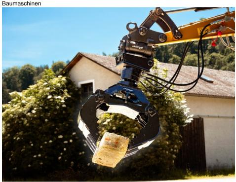
Universalgreifer sind eine ideale Ergänzung für Bagger und erleichtern viele Arbeiten. Sie bieten hohe Flexibilität für Setz- und Sortierarbeiten oder beim Verladen unterschiedlichster Materialien (Bild: Rädlinger).
