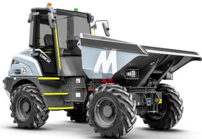
Der »eMDX« ist ein 100% elektrischer 6-Tonnen-Dumper (Bild: Mecalac).
