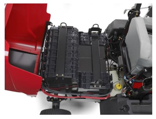
Die »HyperCell«-Lithium-Ionen-Technologie von Toro umfasst ein intelligentes Akkumanagementsystem für gleichbleibende Leistung und optimierte Lebensdauer (Bild: Toro).
