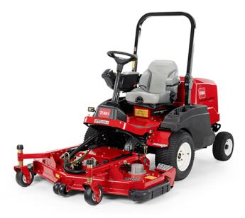
Mit dem eingebauten 3,3 kW Ladegerät kann die Maschine über Nacht aufgeladen werden, um für den nächsten Tag bereit zu stehen (Bilder: Toro).
