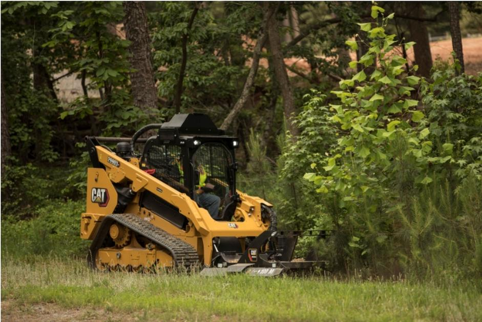
Der Cat »Deltalader 299D3 XE« spielt seine Stärken wie niedrigen Bodendruck besonders im Sport- und Golfplatzbau aus. Seine Laufwerksfederung erhöht die Traktion in unebenem Gelände und verleiht dem Gerät zudem hohen Fahrkomfort (Bild: Zeppelin).
