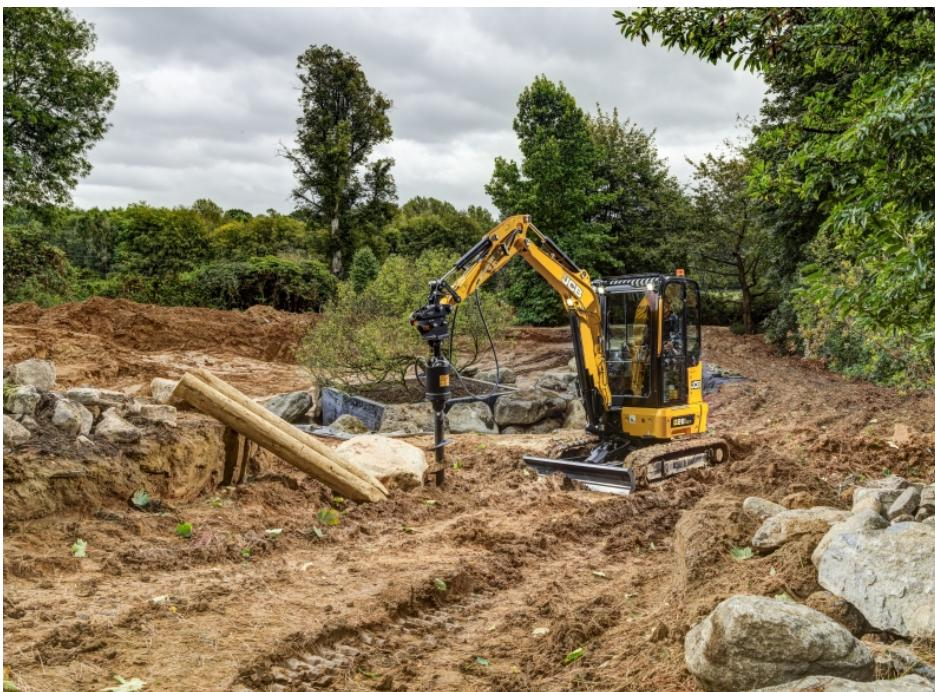
Dank zwei Zusatzleitungen können verschiedene Anbaugeräte mit hohem und niedrigem Hydraulikfluss betrieben werden. Der Fahrer kann bis zu 10 Voreinstellungen bequem von der Kabine aus auswählen (Bild: JCB).
