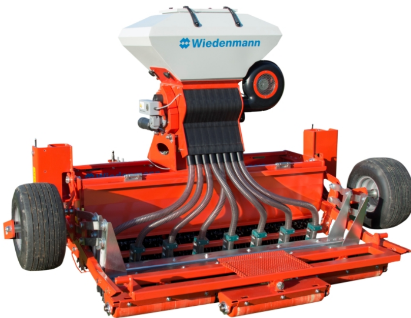
Kombigerät »Terra Float Air« mit drei Funktionen: Bodenlockerung, Topdressing und Nachsaat mit pneumatischem »Airdos«-Dosierer in einer Maschine (Foto:
