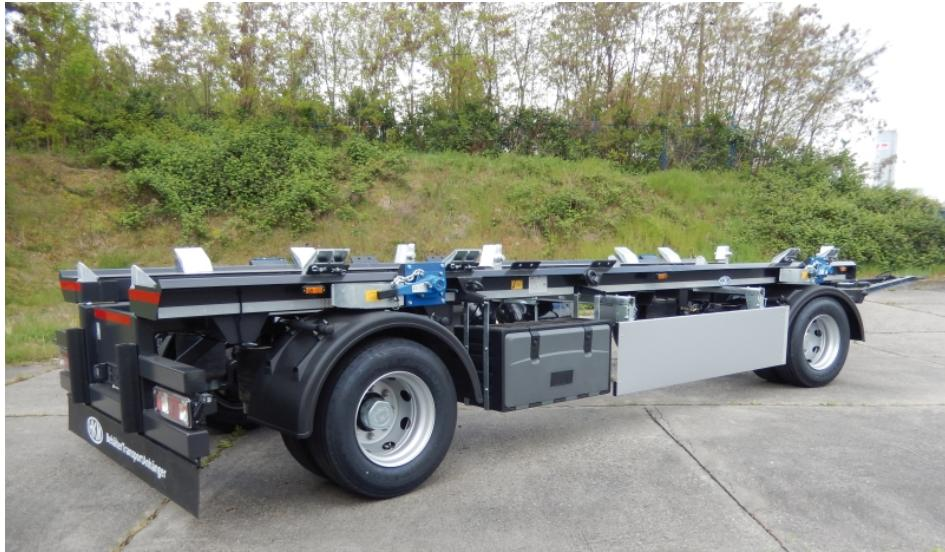
Der HKM Absetzanhänger »A18« kann in dieser Ausführung Absetzmulden als auch Müllpressen transportieren (Bild: HKM).
