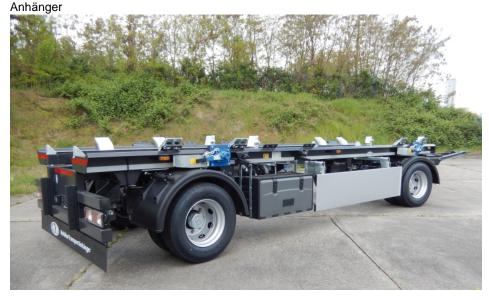
Der HKM Absetzanhänger »A18« kann in dieser Asuführung Absetzmulden als auch Müllpressen transportieren (Bild: HKM).
