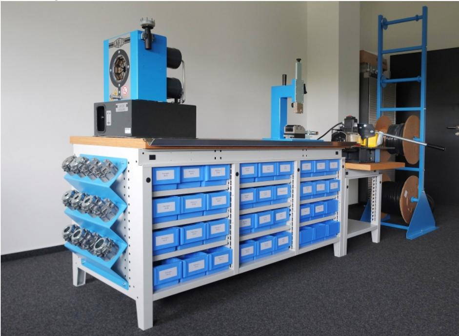
Eine Bank für alle Fälle – Schmitter Hydraulik stellt eine neues Werkstattkonzept zur Konfektionierung von Hydraulikschlauchleitungen vor (Bild: Schmitter Hydraulik).
